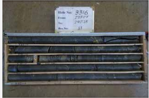
شکل (۳): جعبه مغزه حاوی سنگ آهن مگنتیتی در گمانه ۳۳۱۶
